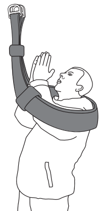
Einstieg bei geschlossener Rettungsschlinge
